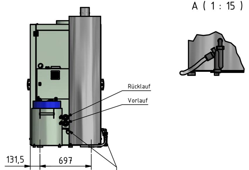
Wahlweise wird ein Kondensatablaufstutzen mit einer Verschlusschraube verschlossen (Lieferumfang)
